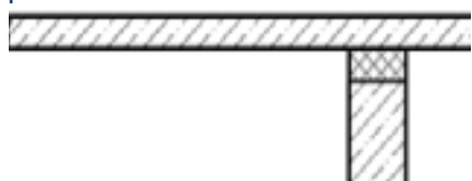
Joint horizontal entre mur et plancher
